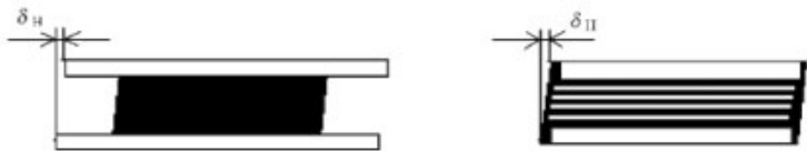
图 3 橡胶支座部的水平偏移测量
